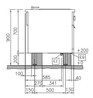
Electrical inlet (power) FΙ Equipotential screw EQ
